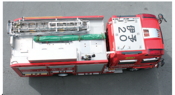
車体上部には、三連はしごや照明装置、ポータブル放水銃、収納ボックスが装備されています。
