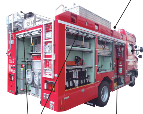
両側面と後面は、各種資機材を積載できるようにシャッター式の収納部となっています。
