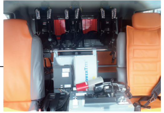
車内には、空気呼吸器をはじめ、安全のため▷各種集中操作盤 ▷ナビゲーションシステム ▷バックモニター ▷ドライブレコーダーなどを搭載しています。
