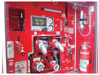
側面は、最新のポンプモニターにより、ポンプの運用状況を把握でき、CAF5の設定などもできます。また、化学消火泡薬剤の混合についても安定したものとなっています。
