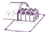
10 リットルまたは 20 リットルのポリタンクに水を入れ、レジャーシートで巻き込み、連結して使用する
