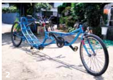
1. 自作の赤いデルタトライクで、愛犬ココちゃんとの散歩を楽しみます 2. 出来たばかり新作は、かねてから思案していた低床LWBリカンベント
