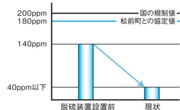
排ガス処理装置設置後の硫黄酸化物排出状況(石炭ボイラー)
