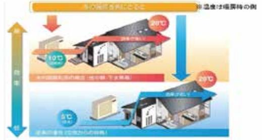
図2-5 下水熱利用方式と空気熱源方式の効率比較
