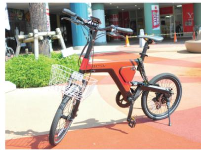
▲電動アシストバイク ペダルの漕ぎ始めをアシストしてくれる自転車。坂道でもスイスイ進むことができる。
