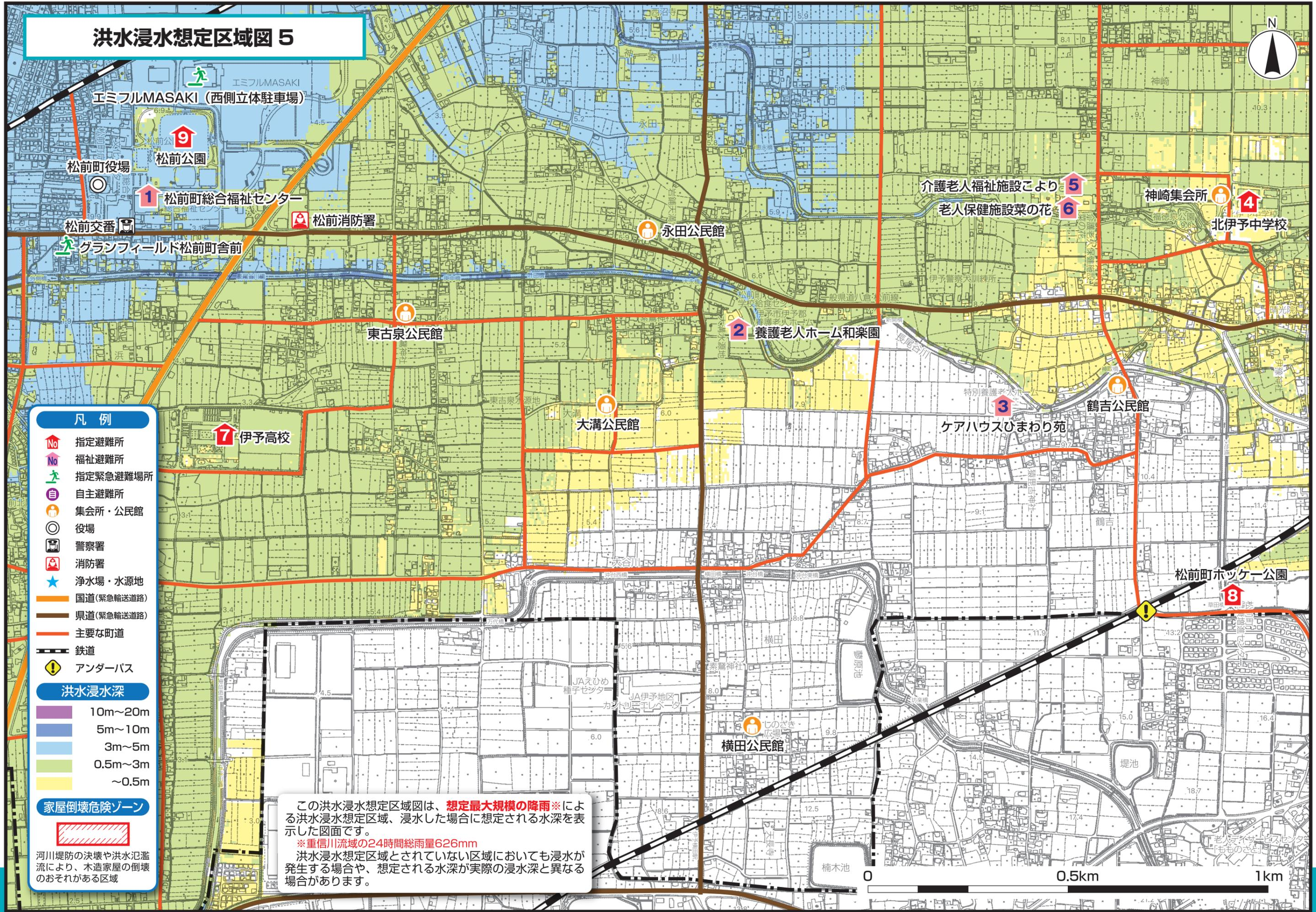
この洪水浸水想定区域図は、**想定最大規模の降雨※**による洪水浸水想定区域、浸水した場合に想定される水深を表示した図面です。
