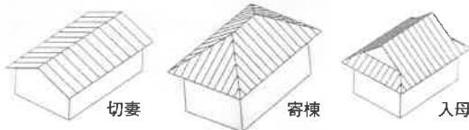
図 屋根の形式 （『物語ものの建築史屋根のはなし』より）
