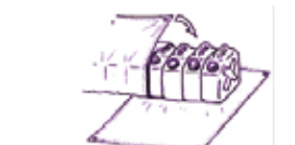
10 リットルまたは 20 リットルのポリタンクに水を入れ、レジャーシートで巻き込み、連結して使用する
