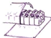
10リットルまたは20リットルのポリタンクに水を入れ、レジャーシートで巻き込み、連結して使用する
