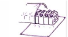
10リットルまたは20リットルのポリタンクに水を入れ、レジャーシートで巻き込み、連結して使用する
