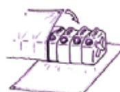
10リットルまたは20リットルのポリタンクに水を入れ、レジャーシートで巻き込み、連結して使用する
