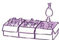
40リットル程度の容量のごみ袋を二重にして、半分の水を入れて閉め、これを段ボールに入れて連結して使用する
