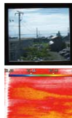
▲サーモグラフィ装置で見た庁舎西側 [温度差は約6℃]
