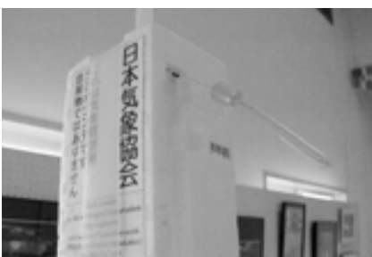
▲軽量化と内部の温度保持のため発泡スチロール製
