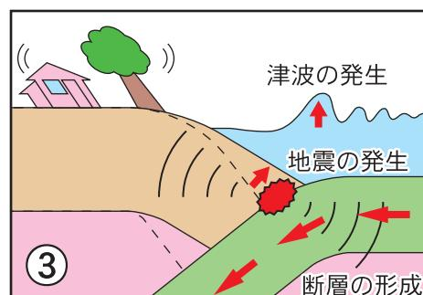
③ 歪みの蓄積が限界に達した時、陸側のプレートが跳ね上がり、地震・津波が発生する。
