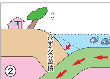
② 陸側のプレートの先端部が引きずり込まれ、プレートに歪みが蓄積する。
