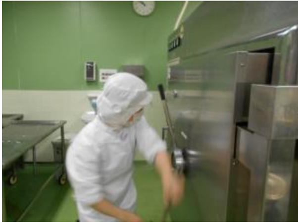
せん切りサラダは蒸煮冷却機で蒸して急速冷却します。
