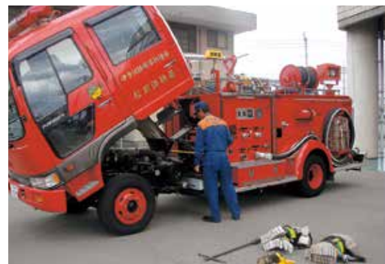
消防車の点検
